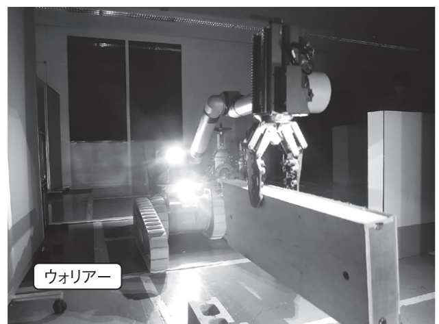
暗闇で障害物を撤去するロボット(提供:支援センター)
